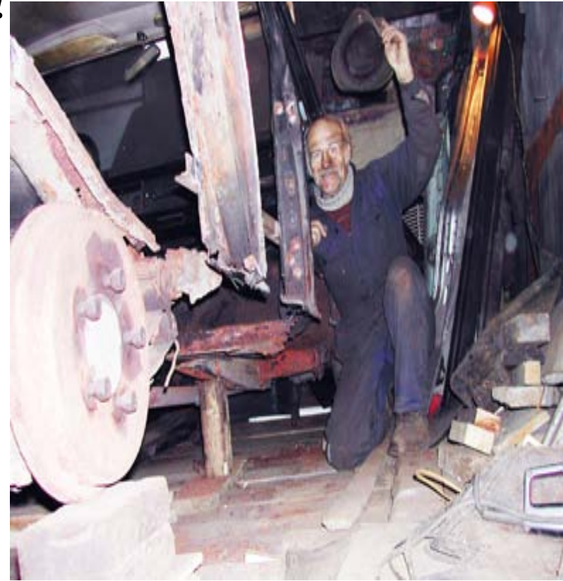
С.Топ меняет днище и правую сторону кузова своей Волги «Газ-24» выпуска 1970 года.
